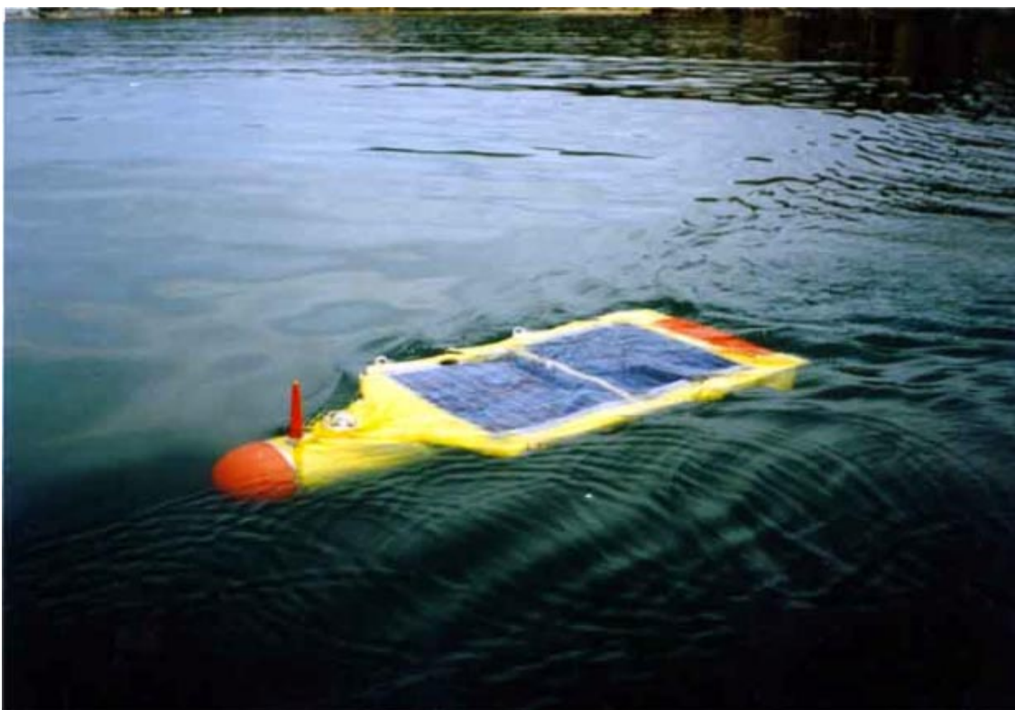
Рис. 2 Солнечный АПР во время подзарядки на поверхности.
