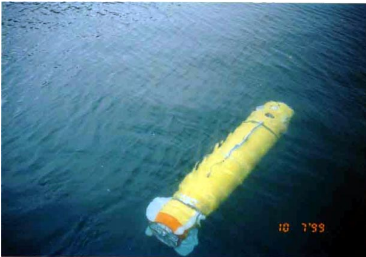
Рис. 3 Автономно-привязной аппарат TSL перед погружением
