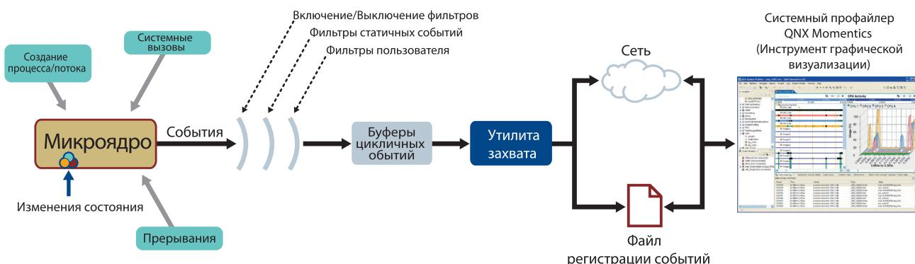
Используя инструментальное ядро вместе с системным профайлером QNX Momentics, вы можете обнаруживать взаимные блокировки потоков, прослеживать корни семантических ошибок, а также целый ряд причин, снижающих производительность системы.
