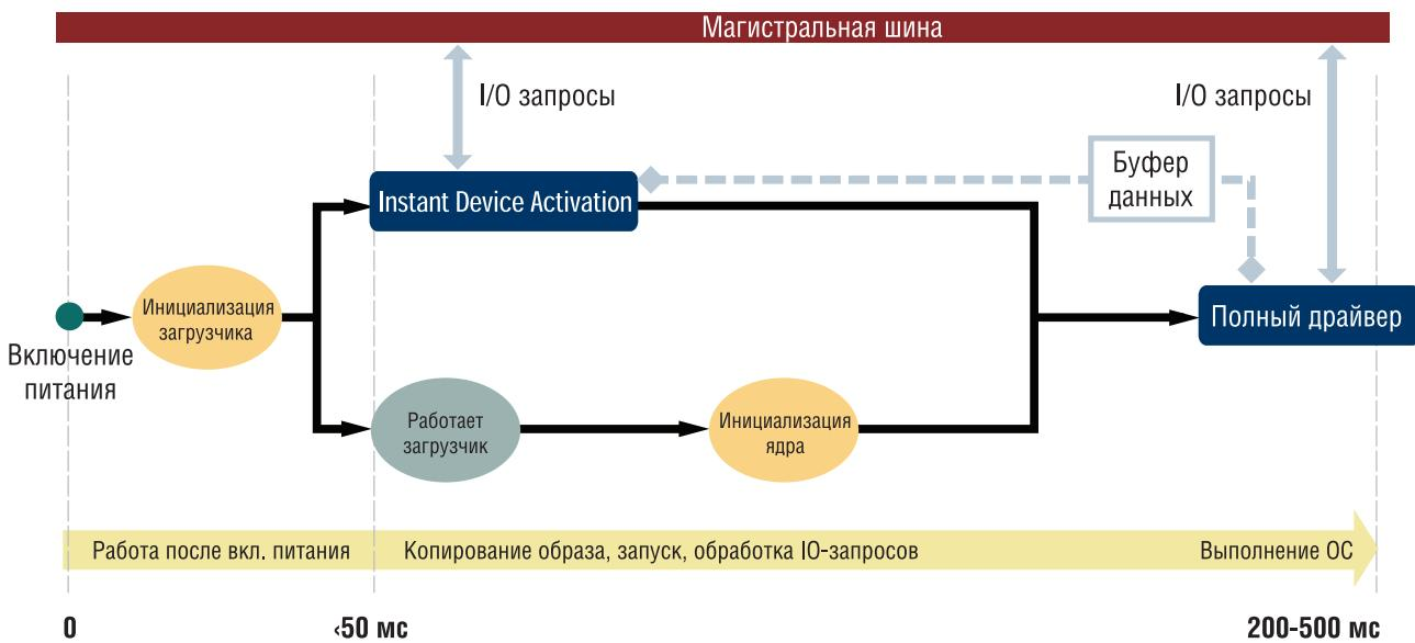
Технология минидрайверов устройств позволяет обеспечивать работу критических функций, таких как отклик на внешние события, критическое время отклика, доступ к аппаратному обеспечению менее чем за 50 мс. Как только управление передается полной версии драйвера, код IDA (называемый также «мини-драйвером») может продолжить или завершить собственную работу — без каких-либо задержек или потерь данных.
