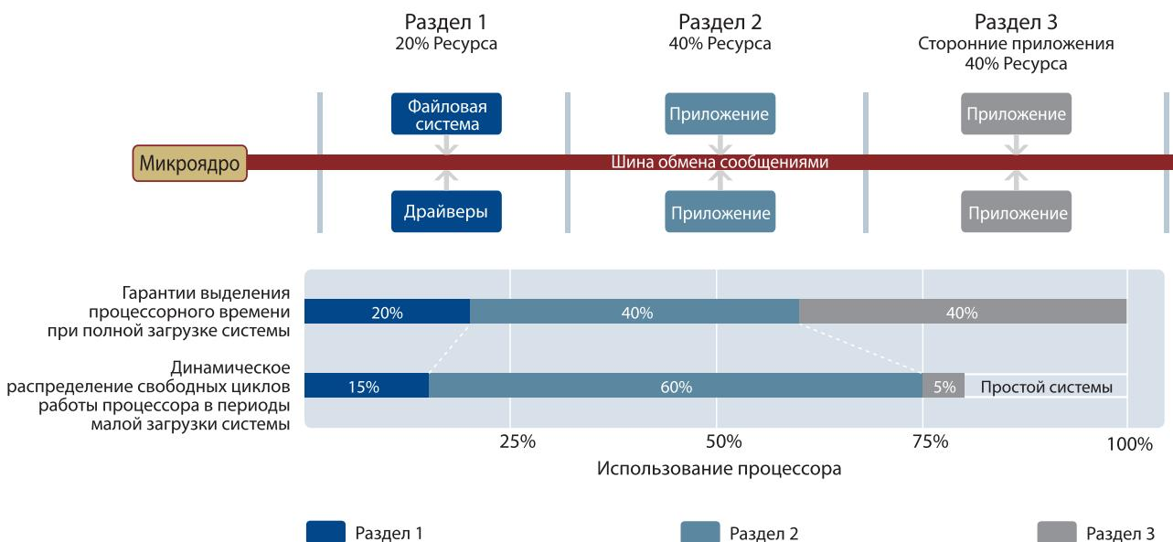
**Запатентованная технология адаптивного квотирования от компании QNX Software Systems позволяет выделять приложениям и процессам гарантированный ресурс процессорного времени при полной загрузке системы, а также динамически распределяет свободные циклы работы процессора в периоды его малой загрузки.**
