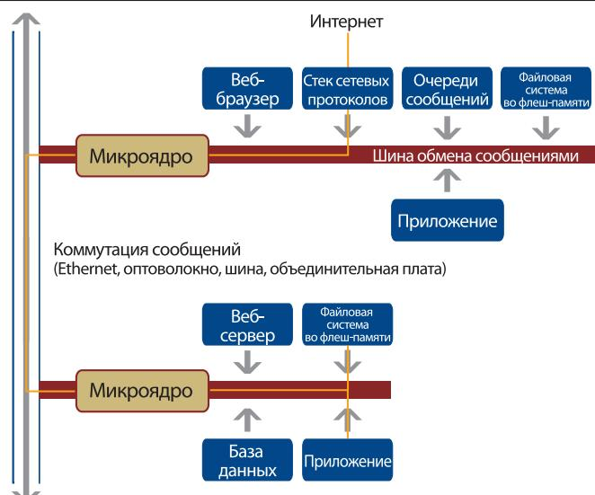
Технология прозрачных распределенных вычислений позволяет приложению получить доступ к любому узлу в сети. Приложения и сервисы могут мгновенно стать распределенными по сети без разработки специального кода.
