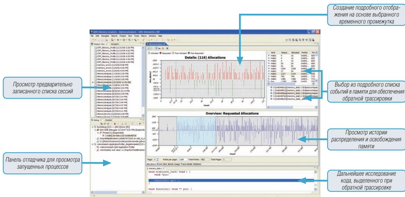
Анализатор ОЗУ обеспечивает визуализацию использования памяти для понимания того, где и как в системе используется память.
